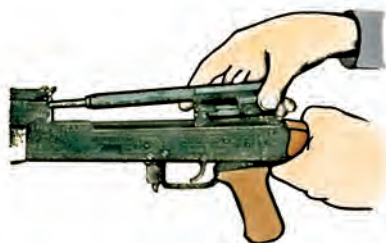
110-сурет. Затвордың рамасын затвормен бірге ажырату.
