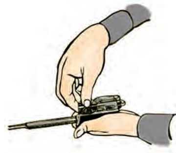
111-сурет. Затвордың рамасынан затворды ажырату.
