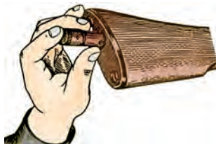
106-сурет. Қарулардың пеналын дүм ұясынан шығару.
