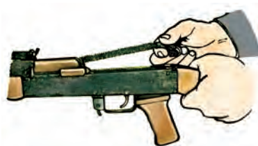
109-сурет. Қайтарушы механизмді ажырату.
