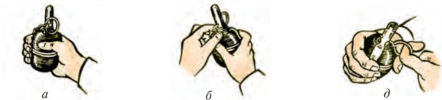
115-сурет. Гранатаны лақтыру алдынан әрекеттендіру: а—граната корпусымен бірге бастаушы рычагты қысып ұстау; б—сактандырғыш алдыңғы шек ақырынан ұстап дұрыстау; в—сактандырғыш шекін үзіп алу.
