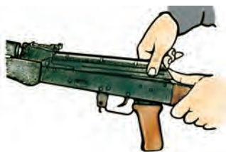
108-сурет. Ствол қорабының қақпағын ажырату.
