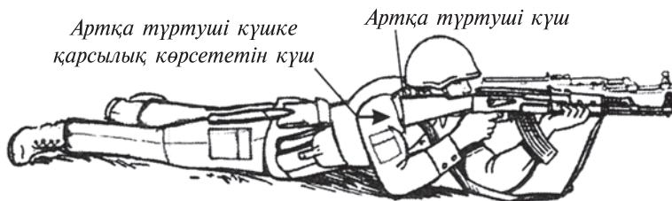
123-сурет. Оқ атуда түртуші күштің әсерінде қару ствол бөлігінің жоғарыға көтерілуі.
