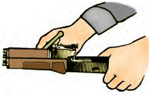
112-сурет. Газ трубасын ствол дүмінен ажырату.
