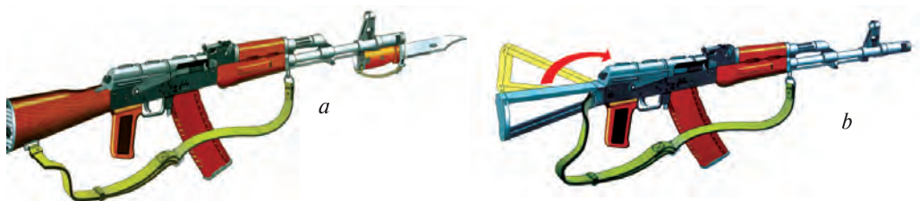
88- súwret . Kalashnikov avtomatınıń ulıwma kórinisi: a — aǵash qundaqlı AK-74; b — qundaǵı búklenetuǵın AKS-74.
