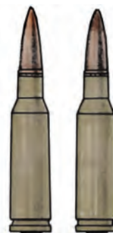
89- súwret . 1974-jilda jaratılǵan 5,45 mm.li ápiwayı hám hawada iz qaldırıwshı oq úlgisi.
