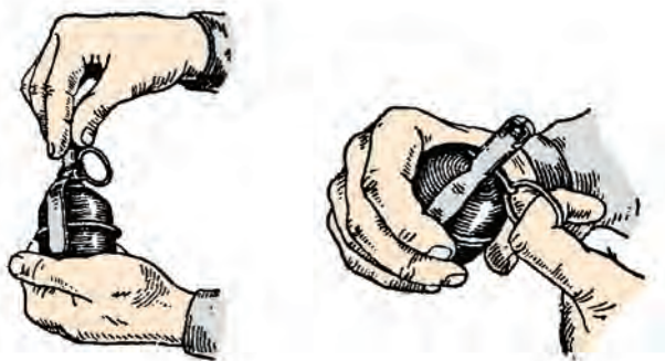
61-súwret. Zapaldı burap qatırıw hám saqlawshı tartqısın shıǵarıw.
