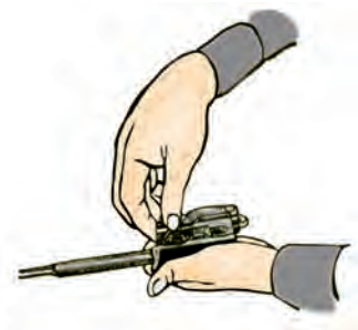
111-súwret. Zatvordı zatvor ramasınan ajıratıw.
