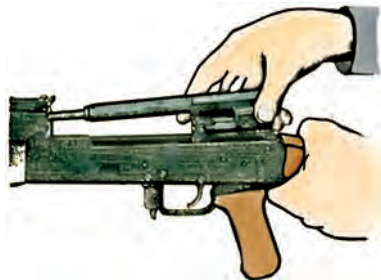
110-súwret. Zatvor ramasın zatvor menen birge ajıratıw.
