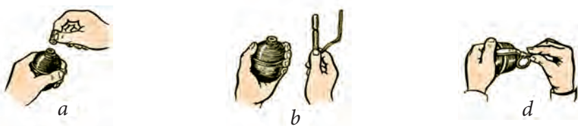
114-nji surat. Böleklere bölünýän el granatalarynyň söweş halaty: a — probkany towlap almak; b — zapaly almak; d — zapaly towlap ornatmak.
