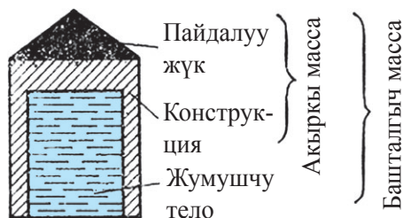
114-сүрөт. Ракетанын структуралык схемасы.
