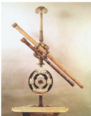
36-сурет. Галилей жасаған бірінші телескоп-рефрактор.
