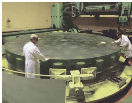
38-сурет. Диаметрі 8 метрлі телескоп айнасын цехта өндеу үдерісі.
