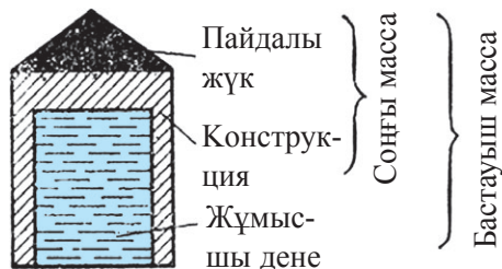
114-сурет. Ракета құрылысы сызбасы.
