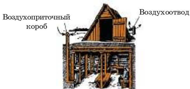
Рис. 21. Простейшее укрытие – подвал
