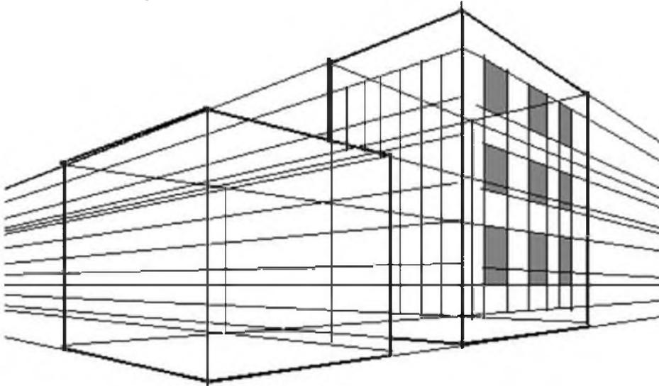
**Рис.30.** Геометрическая форма общего вида здания и угловая перспектива.
