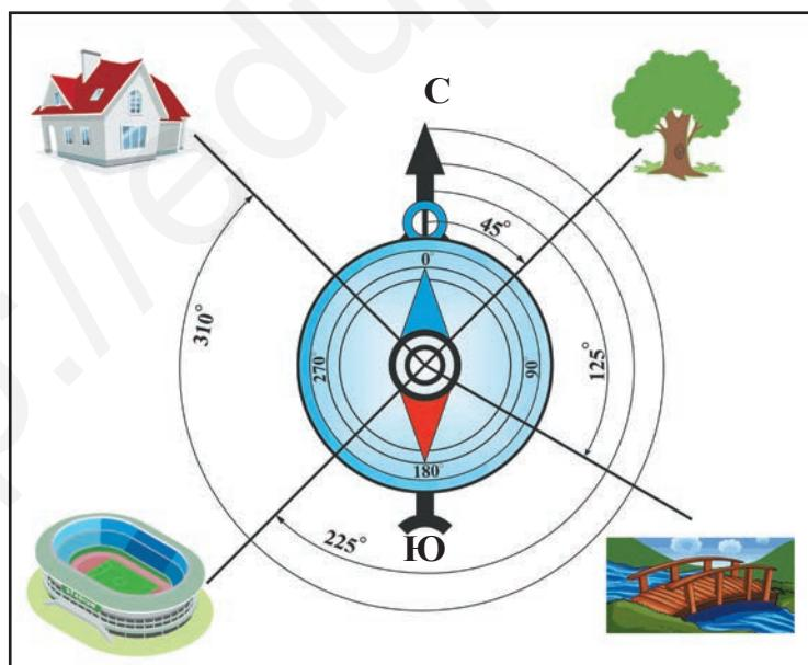
Рис. 16. Определение азимута с помощью компаса
