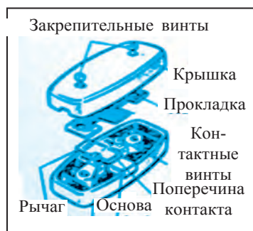
Рис. 75. Строение подвесного выключателя.
