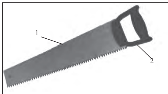
Рис. 42. Строение пилы: 1 – полотно, 2 – ручка.
