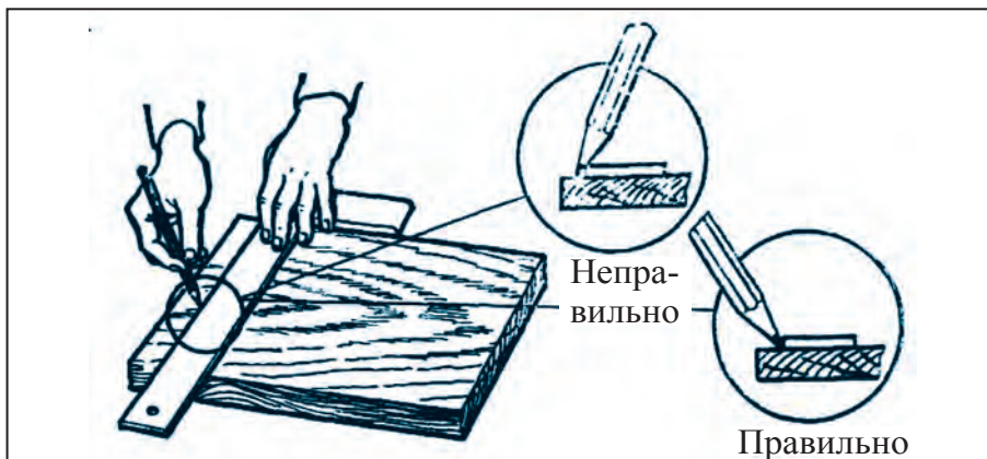
Рис. 41. Проведение линий при помощи угольника.
