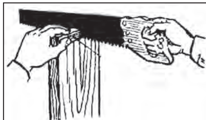
Рис. 46. Установка линии разметки.
