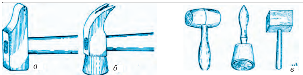
Рис. 57. Столярные молотки и деревянные молотки (колотушки); а) молотки с квадратным обухом; б) с круглым обухом; в) деревянные молотки (колотушки).
