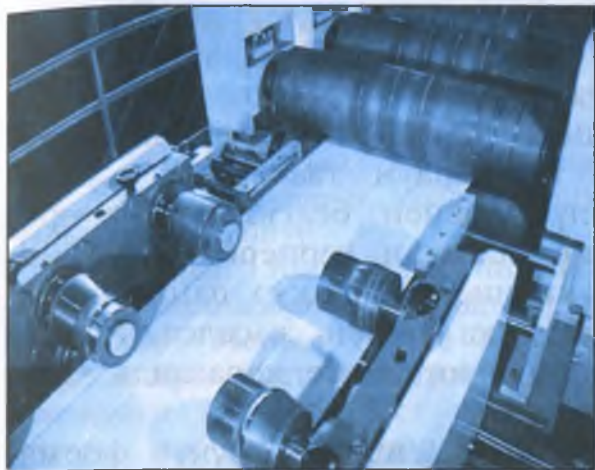
3-сүрөт. Металлды прокаттоо станогун жана анын схемасы.
