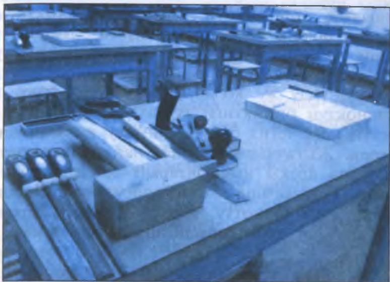
37-сүрөт. Жыгаччылык станогун жана анда шаймандардын жайлаштырылышы.
