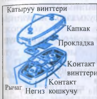
75-сүрөт. Асма включателдин түзүлүшү.
