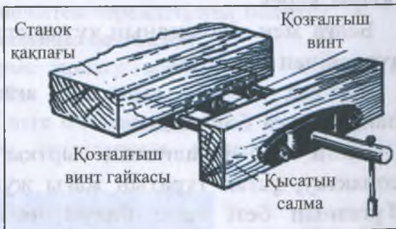
38-сурет. Ағаш өңдейтін станоктың қысқышы.
