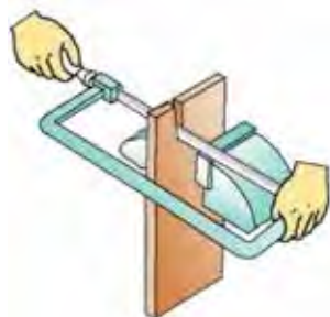
49-сүрөт. Узун металлдарды кыркуу.
