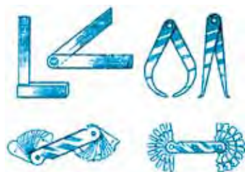
42-сүрөт. Шкаласыз ченөө аспаптары: а – гуния; б – малька; в – кронциркуль; г – нутромер, д – радиус шаблондору; е – резьба шаблондору.
