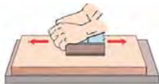
17-сүрөт. Буюмдун бетин кум кагазда жылмалоонун эрежеси.
