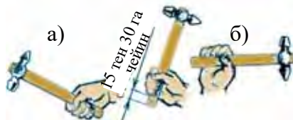
65-сүрөт. Кесүүдө балканын сабын кармоо усулдары: а – манжаларды кыспай; б – манжаларды кысып.
