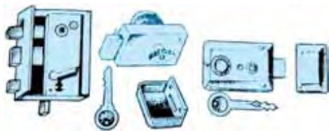
84-сурет. Жабыстырма құлыптар: а - құты сияқты; б - құты сияқты екі айналатын сақтағышты; в - құты сияқты сұрмелі және сақтағыш.
