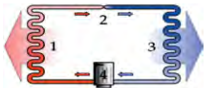
4-сурет. Тоңазытқыштың істеу схемасы.
