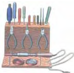
75-сурет. Дәнекерлеуіш үшін астар, жұмыс аспаптары, сондай-ақ дәнекер мен флюстер үшін ыдыстың жұмыс орнында орналасуы.
