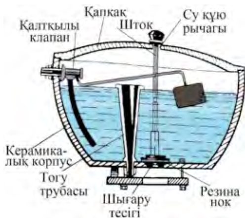
81-сурет. Су құю багінің түзілісі.
