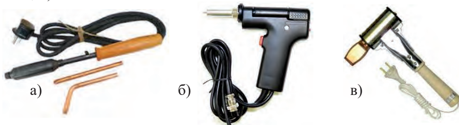
Рис. 77. Паяльники: а – обычный; б – пистолетный; в – долотообразный.
