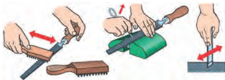
Рис.14. Методы очистки напильника.
