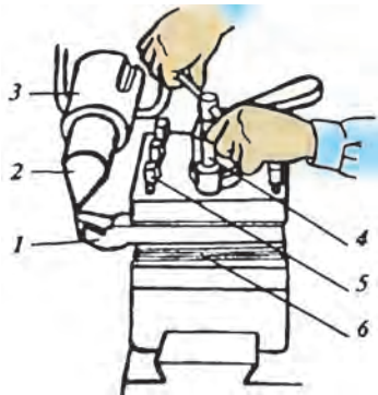
Рис.54. Установление токарного резца на держатель: 1 – резец;
