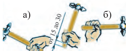
Рис.65. Способы держания молотка при резании: а – не зажимая пальцами; б – сжав пальцы.
