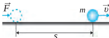
134-сүрөт. v ылдамдыкка жетишкен шарчанын кинетикалык энергиясы
