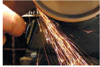
51-сурет. Пышақ өткірлегенде ұшқындардың шашырауы
