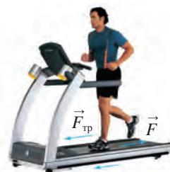
Рис. 108. Движение роликов тредбана вследствие трения
