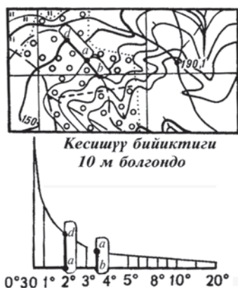
8-сүрөт. Бийиктиктер шкаласынанан капталдардын бийиктигин аныктоо.
