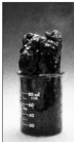
45-сүрөт. Сульфат кислотасынын жыгачка тийгизген таасири
