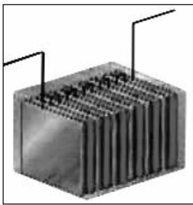
47-сүрөт. Сульфат кислоталуу аккумулятордун батареялары
