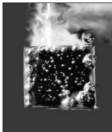
43-сүрөт. Цинктин сульфат кислотасында эриши жана суутектин ажырап чыгышы
