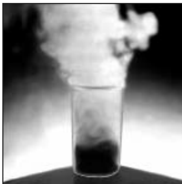
20-сүрөт. \text{H}_2\text{O}_2 ин \text{MnO}_2 нин катышуусунда ажырашы
