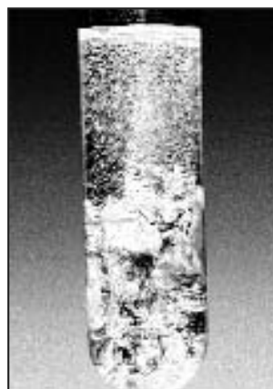
27-сүрөт. Zn тин HCl кислотасынан суутекти сүрүп чыгарышы
