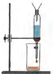
10-сурет. Бір-бірінде ерімейтін сұйықтықтарды айыратын құйғыш
