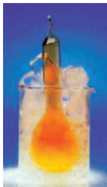
Рис 42. \text{NO}_2 в газообразном и охлажденном виде
