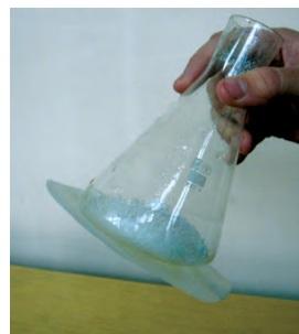
Поглощение тепла и прилипание влажной бумаги ко дну колбы во время реакции
