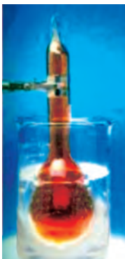
Рис 42. \text{NO}_2 в газообразном и охлажденном виде
