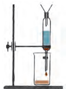
Рис.10. Разделение смеси нерастворимых жидкостей с помощью делительной воронки
