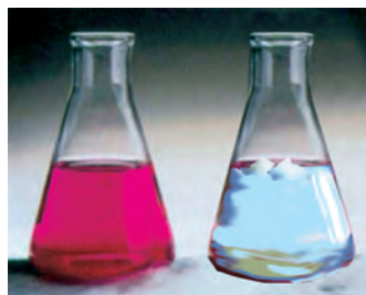
Рис. 41. «Сухой лед» и его взаимодействие с раствором щелочи, содержащим фенолфталеин, в результате которого происходят его нейтрализация и исчезновение окраски индикатора
