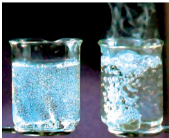
Рис.36. Взаимодействие цинка с растворами серной кислоты различной концентрации
