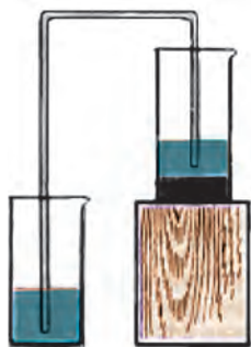
Рис.9. Получение чистой воды путем отстаивания
