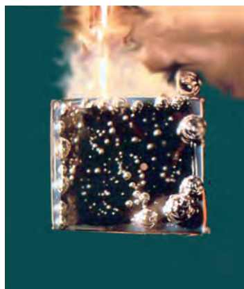
Рис.45. Растворение цинка в серной кислоте и выделение водорода
