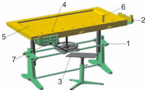
7-сурет. Ағаш шеберлігі станогы: 1 – негіз, 2 – қысқыш, 3 – жұмыс үстелі, 4 – көмекші ұялар, 5 – жөндеу орны, 6 – көмекші сүйеніштер, 7 – тістеуік.
