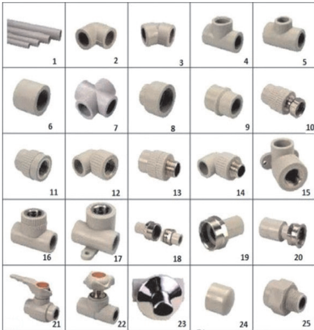
21-сурет. Пластмасса құбырына орнатылатын арнайы құрылғылар. 1 – құбыр, 2 – 90 0 -ты бекіткі қолтаңба, 3 – 120 0 -ты бекіткі қолтаңба, 4,5 – тармақтағыш, 6 – тура бекіткі қолтаңба, 7 – тегіс тармақтағыш, 8,9 – өлшемді ұзайтырушы бекіткі қолтаңба, 10,11 – сыртқы темір-пластмасса бекіткі қолтаңба, 12 – сыртқы 90 0 -ты темір-пластмасса бекіткі қолтаңба, 13 – ішкі тура темір-пластмасса бекіткі қолтаңба, 14,15 – ішкі 90 0 -ты темір-пластмасса бекіткі қолтаңба, 16,17 – тармақталудан ішкі 90 0 -ты темір-пластмасса бекіткі қолтаңба, 18,19,20 – сыртқы темір бекіткі қолтаңба, 21,22 – пластмасса кілт, 23 – темір бекіткі қолтаңба, 24 – тоқтатқыш, 25 – бұрап тоқтатқыш.
