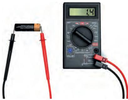
Biziň galwanik elementimiziň naprýaženiýesi 1,5 V tòwereginde bolanlygy üçin, multimetriň wintiniň ölçeg çägi diýip 20 görkezilen nokada gabatlap goýýarys. Multimetriň COM we V,  $\Omega$ , mA gysgyçlaryna birikdirilen birikdiriji simler tok çeşmesiniň polýuslaryna birikdirilýär. Tok çeşmesiniň naprýaženiýesiniň bahasy multimetriň tablosyna çykýar (70-nji surat).
