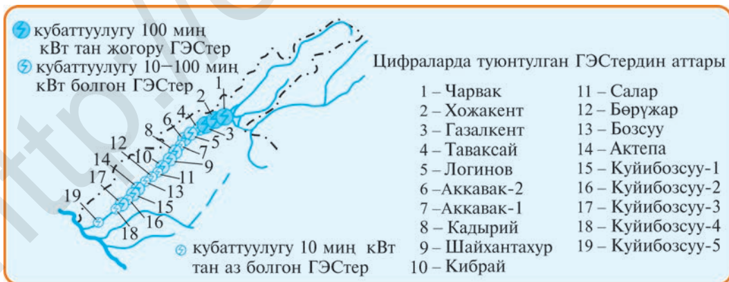
31-сүрөт. Чырчык-Бозсуу гидроэнергетика каскады.
