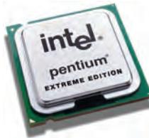
Қазіргі заманғы компьютерлердегі процессордың қызметін, көлемі 10 текше мм-ден де кіші, электр тогын шала өткізетін заттан (кремний я германийден) істелген, жалғыз кристалда орналасатын, миллиондан ұсақ транзистордан тұратын микропроцессор, яғни тығыздығы өте жоғары интегралдық схема атқарады. Мысалы, Intel Pentium Pro микропроцессорының ішінде 5,5 миллионнан астам транзистор бар.
