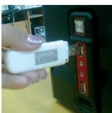
Дискжетек, принтер, флеш-зерде сияқты құрылғылар негізгі платаның **порт** деп аталатын арнаулы жеріне қосылады. Бұл құрылғыларды басқару үшін негізгі платада **контроллер** деп аталатын электронды схемалар бар. Порттар параллель (LPT), тізбекті (COM)
