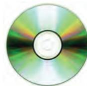
Оптикалық дискінің спираль тәріздес жалғыз жолшығы бар. Лазер сәулесі дискінің бетін күйдіріп, биік не төмен із қалдырып, ақпаратты бөлек секторларға жазады. Ақпаратты оқу барысында биіктіктер лазер сәулесін шағылтады, сондықтан олар “1” деп, ал төмендіктер лазер сәулесін сініргендіктен — “0” деп қабылданады. DVD-ROM құрылғысындағы лазер сәулесінің толқын ұзындығы CD-ROM құрылғысына қарағанда біраз қысқа болады. Сол себепті DVD дискіге тығызырақ, яғни көбірек ақпарат жазуға болады.
