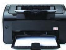
**Принтер** – ақпаратты қағазға басып шығаратын құрылғы. Қазіргі уақытта принтерлердің үш түрі бар, бұлар – матрицалық сокпалы принтер, бүріккіш және лазер басу принтерлері. Принтерлердің сокпалы түрі қазір пайдаланылмайды.
