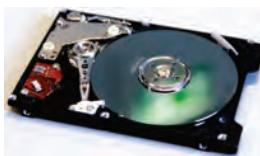
Қатты дискілерге жазу және оқу – магниттеу құбылысына сүйенеді, сондықтан оларды қатты магнитті дискілер деп атайды. Бұл құрылғы жалпы корпусқа жайғасқан, электр қозғалтқышы, магнит бастиегі (орыс. – головка), позициялау
