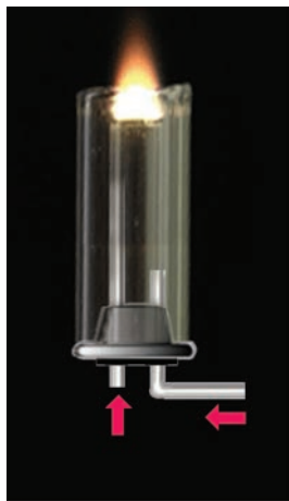
Рис. 25. Горение аммиака в кислороде
