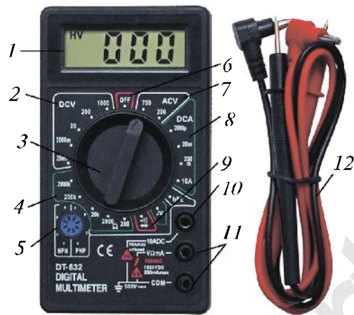
22-сүрөт. DT-832 маркалуу мультиметрдин түзүлүшү: 1 — дисплей; 2 — туруктуу чыналууну өлчөө; 3 — переключатель; 4 — каршылыкты өлчөө; 5 — транзисторлорду текшерүү уячасы; 6 — өчүрүү; 7 — өзгөрмө чыналууну өлчөө; 8 — токту өлчөө; 9 — туруктуу чыналууну өлчөө; 10 — 10 А болгон токту өлчөө; 11 — аныктагычтар үчүн уяча; 12 — өлчөө зымдары (шуптар).
