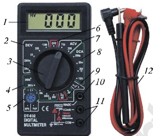
22-сурет. DT-832 маркалы мультиметрдің құрылымы: 1 – дисплей; 2 – өзгермейтін күштеуіп өлшеу; 3 – переключатель; 4 – қарсылықты өлшеу; 5 – транзисторларды тексеру ұясы; 6 – өшіру; 7 – өзгерушең күштеуіп өлшеу; 8 – токты өлшеу; 9 – өзгермейтін күштеуді өлшеу; 10 – 10 А болғап токты өлшеу; 11 – апықтағыштар үшін ұяшық; 12 – өлшеу сымдары (шұптар).
