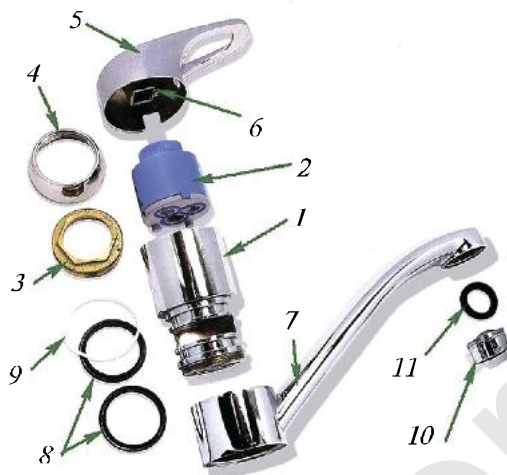
16-сурет. Бір рычагты смеситель қондырғысының құрылымы: 1 – металл корпус; 2 – картриж; 3 – картрижді пықтап ұстап тұратын гайка; 4 – декоративті қақпақ; 5 – смеситель тұтқасы; 6 – смеситель тұтқасы астында орналасқан квадрат пішініндегі ұстағыш; 7 – айналмалы тұмсық; 8, 11 – резиналы шенбер; 9 – фторопластикалық шенбер; 10 – аэратор (қорғау торы).
