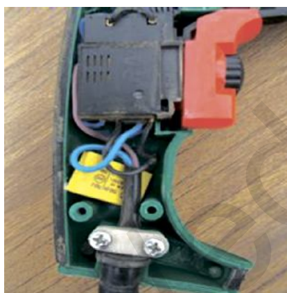
Расми 21. Соҳти дохилии дастаки электродрел (а) ва схемаи тугмаи ба кор дароваранда (б).
