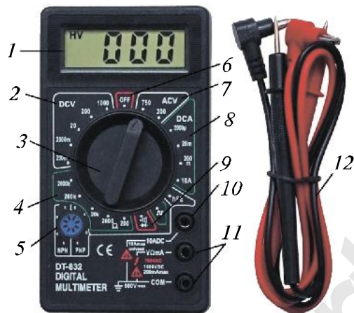
Расми 22. Сошти мултиметри тамгаи DT-832: 1 — дисплей; 2 — ченакӣ қувваи тағйирнопазир; 3 — переключател; 4 — ченкунии муқовимат; 5 — ҳоначаи санҷидани транзисторон; 6 — ҳом-шкунӣ; 7 — ченкунии қувваи тағйирпазир; 8 — ченкунии ток; 9 — ченкунии қувваи тағйирнопазир; 10 — ченкунии токи 10 А; 11 — ҳонача барои аниққунандаҳо; 12 — симҳои (шупҳои) ченак.
