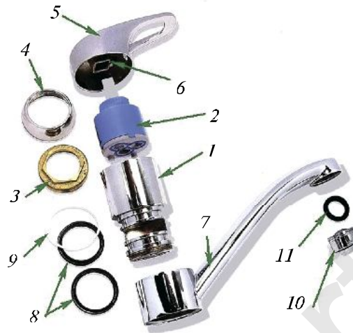
Расми 16. Сохти асбоби смесители якфишанга (якричагдор): 1—корпуси металлӣ; 2—картриҷ; 3—гайкаи картиҷро маҳкамдоранда; 4—сарпӯши декоративӣ; 5—дастаки смесител; 6—дастираки дорои шакли мураббаъ, ки зери дастаки смесител ҷойгир аст; 7—бинии даврзананда; 8, 11—ҳалқаҳои резинӣ; 9—ҳалқаи фторопластикӣ; 10—аэратор (тӯри ҷимоя).
