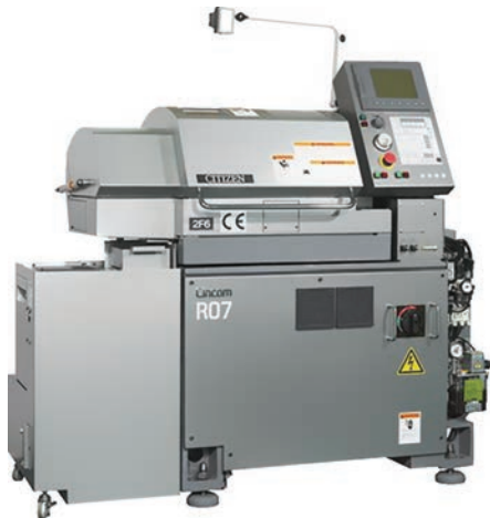
Рис. 17. Современный металлообрабатывающий станок «CitizenR07-VI» с автоматическим управлением
