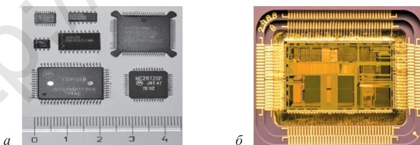
Расми 23. Асбобҳои ҳисобкунии рақамӣ: а – корпуси интегралӣ микросхема; б – корпуси микропроцессор.
