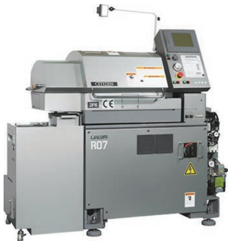
17-nji surat. «Citizen R07-VI» awtomatik ýagdaýda dolandyrylýan häzirkî zaman metal işläp bejerýän tokar stanogy.
